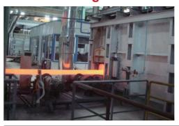
该项目加热炉适应热装热送,适应快节凑,高自动化的要求, 最终实现全自动出钢、钢坯加热质量高,温度均匀性好,氧化烧 损率低。
