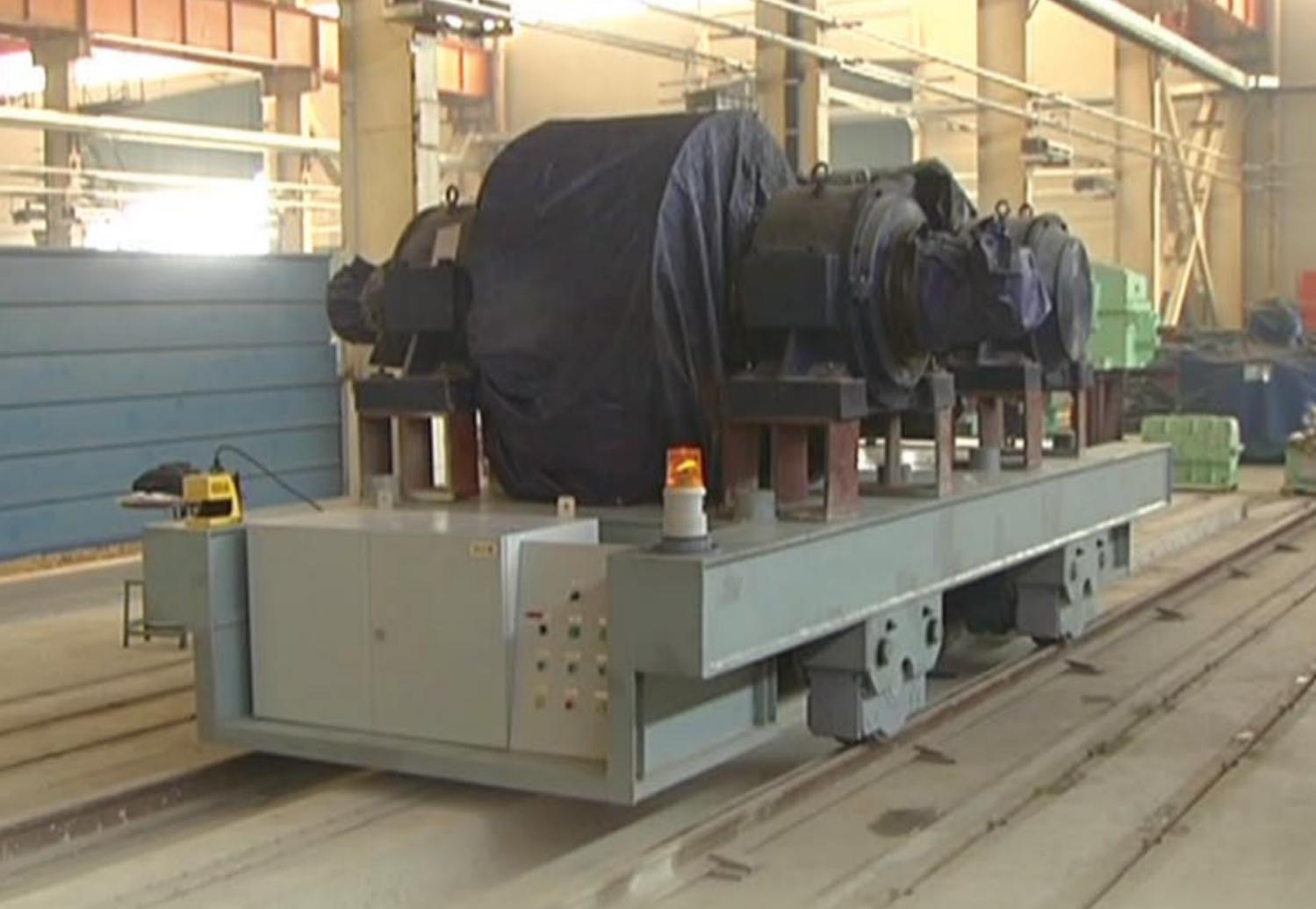
国内首例60t非接触供电钢卷运输车通过工程模拟试验
