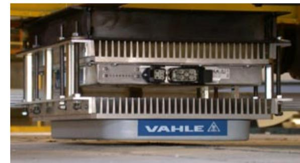
拾电装置与地面供电系统无接触
